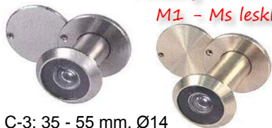
C-3: 35 - 55 mm, Ø14 C-5: 60 - 85 mm, Ø16 priezorník (kukátko) na hrubé dvere
