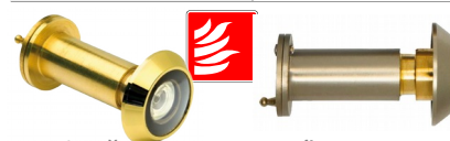
Protipožiarný priezorník, EI30. Šošovka z ohňovzdorného skla, telo z mosadze, Ø14, 35-55mm.
